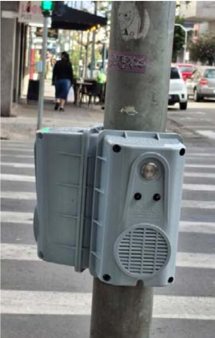
BOTOEIRA de acessibilidade no centro de Poços
